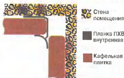
Рис. 5. Заделка внутреннего угла пластиковой раскладкой
