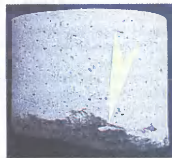
Сетка не остается в середине плиты, где она укрепляет заливку, а сталкивается вниз, где от нее пользы мало
