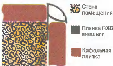
Рис. 4. Заделка наружного угла пластиковой раскладкой
